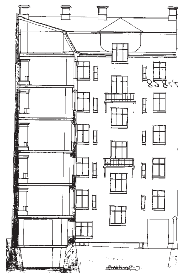
Gårdsfasad Kastellgatan 4, takfall mot gård utan takkupor, med undantag för trapphuset. Källa: SBK.
