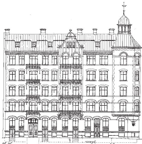
Originalritning gatufasad Risåsgatan 5/Kastellgatan 12 uppförd 1900 efter ritningar av Oscar W Nilsson i tidstypisk eklektist stil med hörntorn och hörnkedjor som gav ett borgliknande utseende. Källa: SBK.
